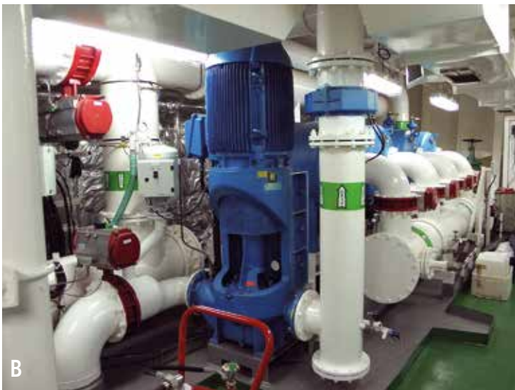
Sistema antiguo de bombeo de agua de lastre en la sala de máquinas (A) y sistema moderno de tratamiento de agua de lastre (B).
